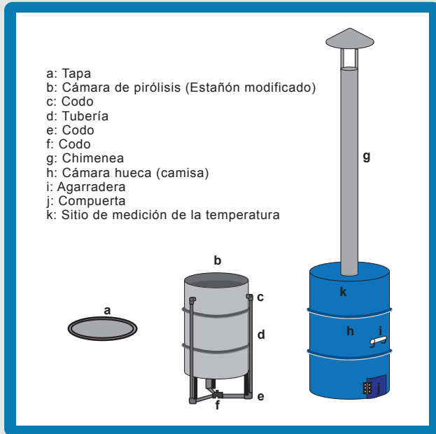
Figura 15. Partes de un carbonizador, elaborado en el ITCR, para la producción de biocarbón.
