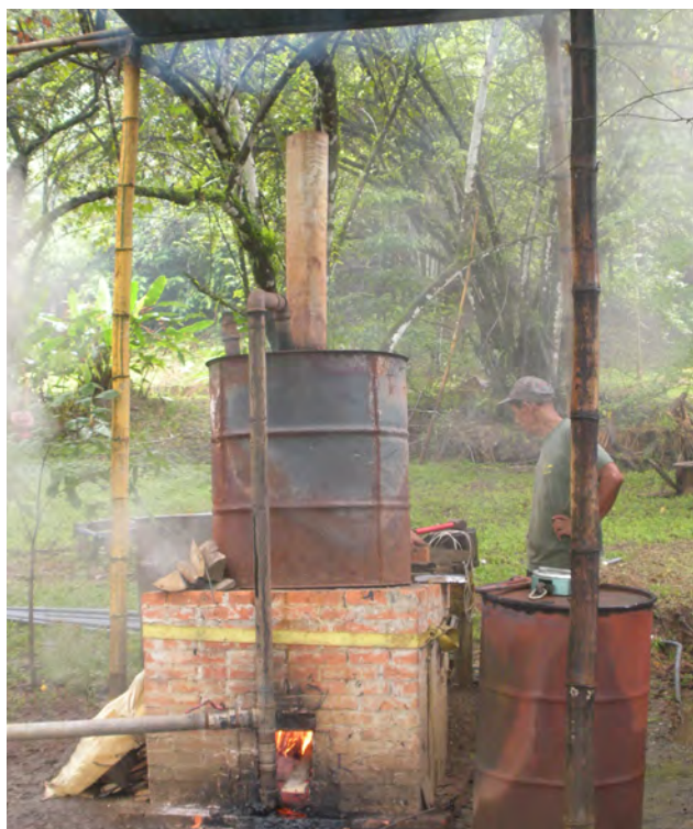
Fotografía 4. Hornito utilizado por el proyecto del CATIE en la península de Osa: cámara de combustión en ladrillo, con doble estañón para la cámara de pirólisis, donde se agrega la madera que se convertirá en biocarbón. Diseño del Horno: Robert Lerner.
